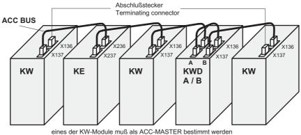
eines der KW-Module muß als ACC-MASTER bestimmt werden one of the KW modules must be determined as the ACC MASTER
