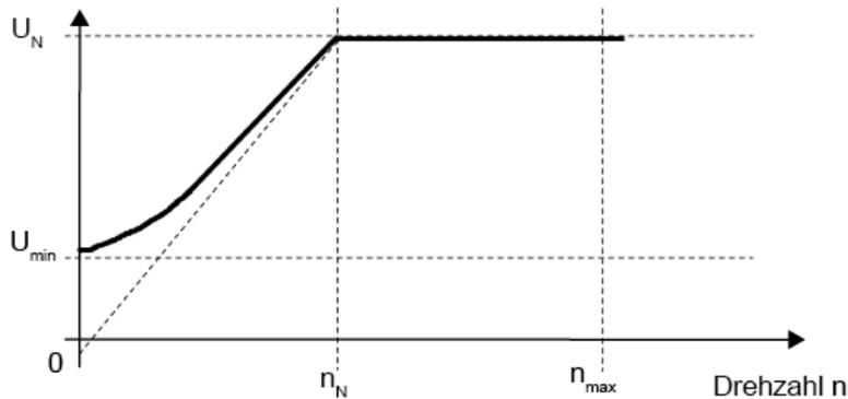
$U_N$ : ID32768 'Nennspannung Motor'
