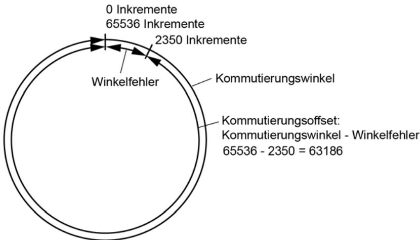
Der elektrisch ausgerichtete Synchronmotor zeigt z.B. einen Kommutierungswinkel von ID32831 = 2350 Inkremente (Winkelfehler) an. Um diesen Wert auf Null zu kompensieren wird der Kommutierungsoffset wie folgt berechnet:
