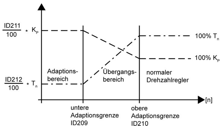
Unterhalb der unteren Adaptionsgrenze wirken  $K_p$  und  $T_n$  nach ID211 und ID212, oberhalb der oberen Adaptionsgrenze wirken  $K_p$  und  $T_n$  nach ID100 und ID101, dazwischen wird linear angepasst.
