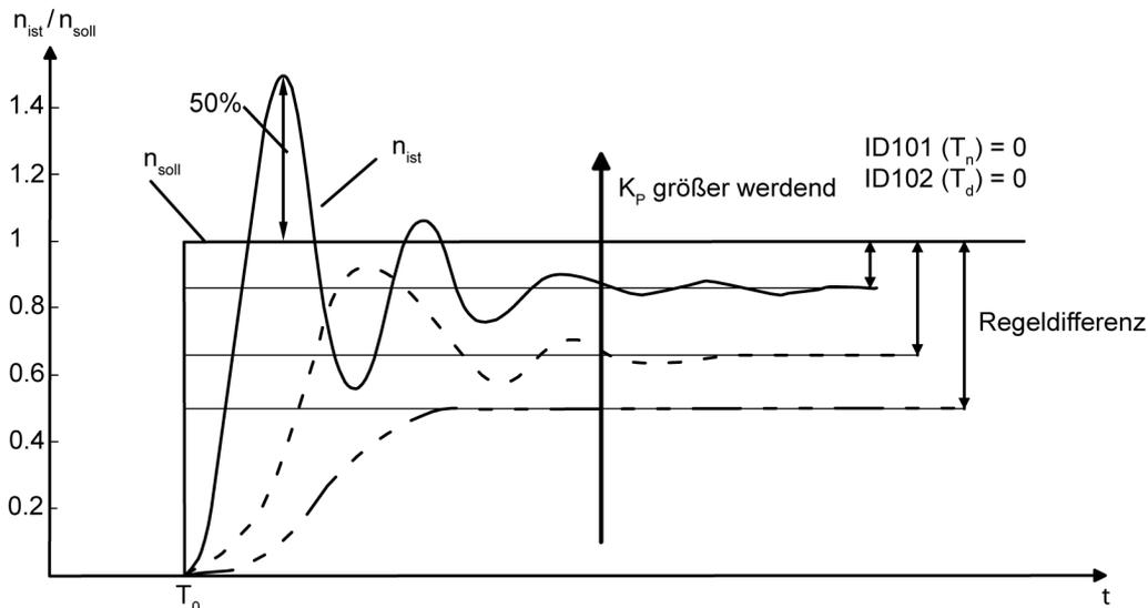
Verlauf der Istdrehzahl des Drehzahlregelkreises bei sprunghafter Änderung des Drehzahlsollwertes in Abhängigkeit von  $K_P$  (ID100).
